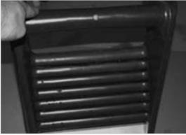
Filter regelmäßig kontrollieren. Dazu Deckel vom Filter heben, eventuelle Verunreinigungen aus der Wanne spritzen, dann Filtereinsatz rausziehen.
