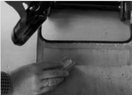
Sollten Verschmutzungen vorhanden sein, Sieb beidseitig mit Seifenlauge und Bürste reinigen. Sieb gut durchspülen, Funktionstest durchführen.
