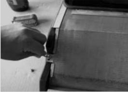
Sieb vom Filtereinsatz lösen. Dazu Schrauben lösen und Sieb entnehmen. Sieb gegen das Licht halten und überprüfen, ob die Maschen frei sind.
