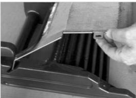
Sieb wieder in den Einsatz schieben und anschrauben, bei der Volledelstahl-Ausführung darauf achten, dass das Sieb parallel zum seitlichen Ausschnitt sitzt (die Dreiecke müssen genau übereinander liegen). Filtereinsatz wieder einsetzen.
