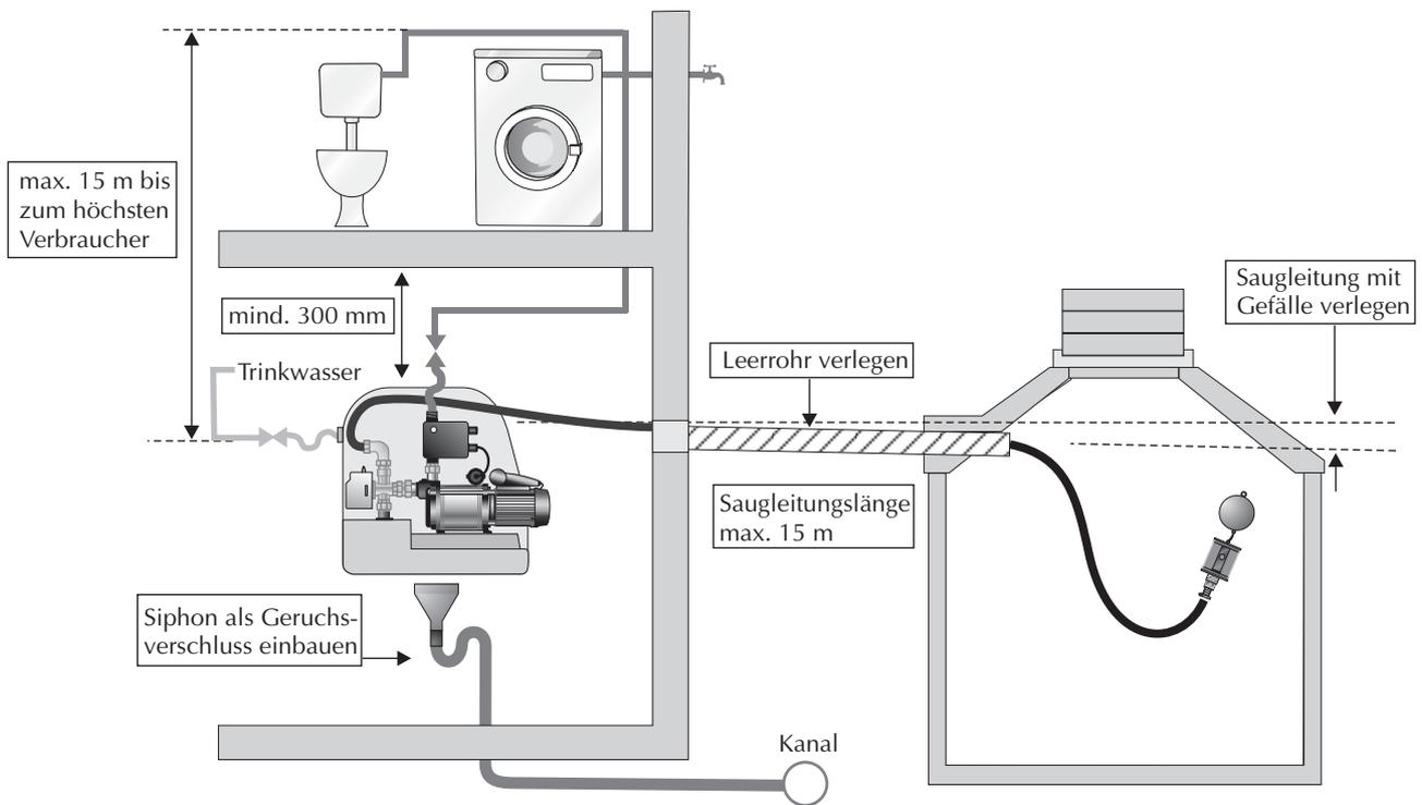
Bild 9 Hydraulischer Anschluss der EcoBox Easy
