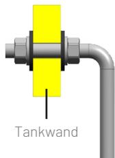
Beachten Sie beim Einstecken der Gewindestange, dass sich die Dichtung zwischen Tankwand und Beilagscheibe befindet. Von außen die zweite Dichtung, eine Beilagscheibe und die Mutter montieren.
