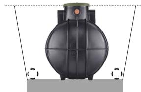
bei wasserundurchlässigen Böden drainieren!
