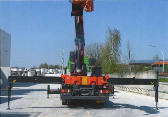
Unsere neuen Krawanwagen sind Computergesteuert und damit in der Leistung begrenzt. Um beim Entladen die volle Leistung abrufen zu können, benötigen wir eine Aufstellfläche von 10m Länge und 9m Breite für die Stützen. Können die Stützen nur zu 60% ausgefahren werden, gibt der Kran nur 60% Leistung zum Heben frei.
