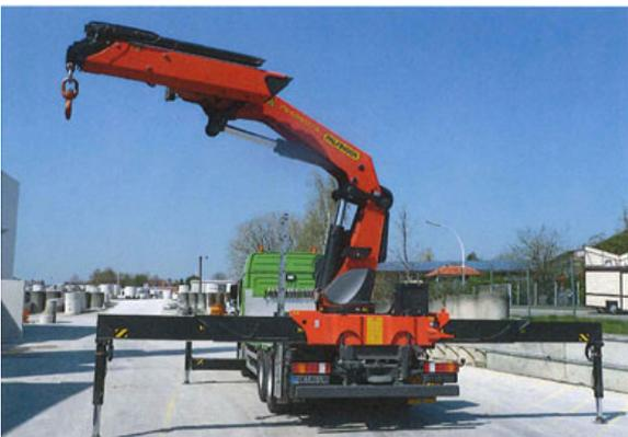
Bei einer seitlichen Entladung kommen wir bei maximaler Leistung von 9to nicht weiter als Außenkante Stützen mit dem Mittelpunkt vom Behälter. Beim Versetzen in die Baugrube sind meistens die Stützen im Weg.
