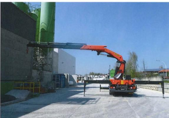
Bei einem maximalen Stückgewicht von 4to. haben wir eine maximale Auslegung von 9,60m. Hier kann man seitlich entladen, muss aber immer berücksichtigen, dass die Stützen an BEIDEN Seiten voll ausgefahren sein.
