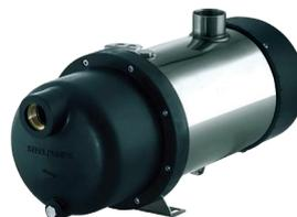
Diese Pumpe verfügt über eine integrierte, elektronische Steuerung, kann als Saug- oder als Tauchpumpe aufgestellt werden, arbeitet vollautomatisch und ist somit perfekt für die Gartenbewässerung geeignet. Sobald ein Wasserverbraucher (Gartenschlauch, Wasserhahn, ...) geöffnet wird, schaltet sich die Pumpe automatisch ein (integrierter Durchflusswächter). Der integrierte Trockenlaufschutz schaltet die Pumpe im Bedarfsfall automatisch ab.
